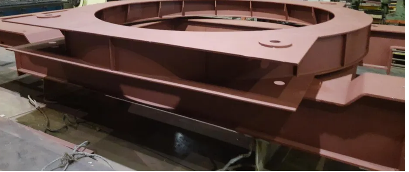
İmalat detayı: hurda sepeti transfer arabası gövdesi
